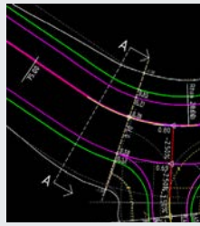
Figuur 3: Een voorbeeld van een Plan Callout. Deze kan ook in een 2D model geplaatst worden, met het 3D model als referentie.
