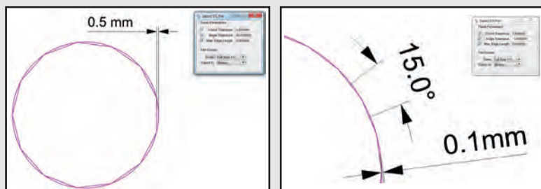
De Chord Tolerance (in dit geval 0,5 mm) is de maximale afstand tussen de originele cirkel en de rechte lijntjes.
