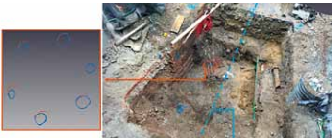
Deze horizontale doorsnede van het betonstaal toont een nauwkeurige vergelijking tussen fotogrammetrie en laserscannen (TLS, terrestrial laser scanning): de blauwe cirkels staan voor de fotogrammetrie en de rode voor TLS; maximale afwijking is 6-10 millimeter.
