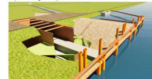
Step 11 - aanbrengen westelijke helft duiker
