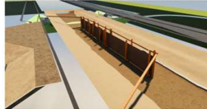
Step 3 - leggen kanaalbodem t.p.v. dammen en drempelconstructie
