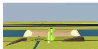
Step 8 - inlagen, opbreken en afvoeren taludbekleding (beton, steen en asfalt) Step 9 - ontgraven kaden en vulgemaal materiaal vervoeren in dempelconstructie
